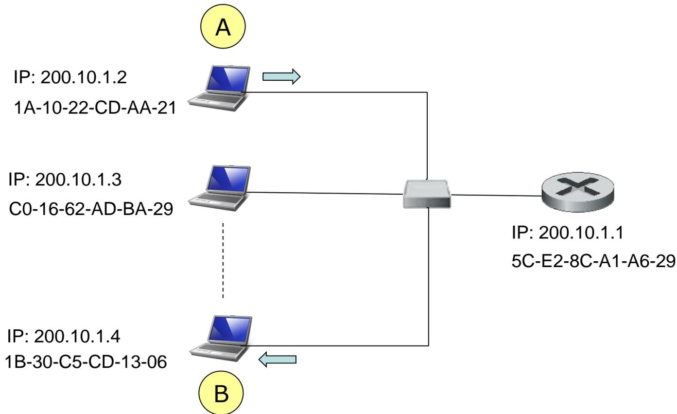
Ogni nodo di una LAN ha un indirizzo IP e l'adattatore di ogni nodo ha un indirizzo LAN.
